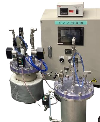
①ギ酸溶液と触媒を反応させる装置
